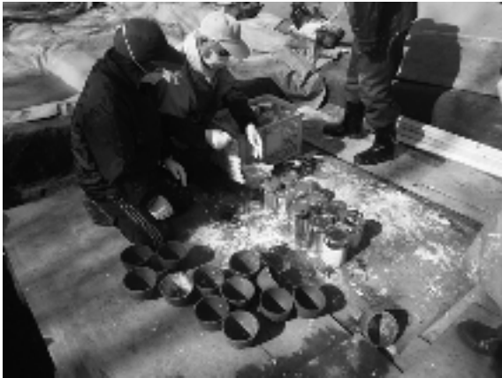
(5) シリコン樹脂の大量製作（洗面器などの大型容器も考えたが、硬化剤を確実に混合させるにはラバーボウルが最適な容量で扱いやすかった。）
