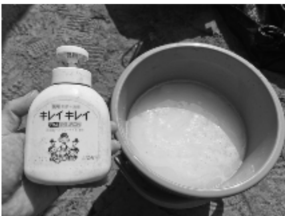
(3) 離型を促す石鹼水（事前テストでは、石鹼水を画仙紙に塗布したほうが食い付かず離型に適することを確認し採用した。）
