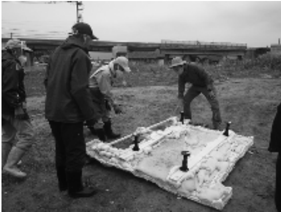
(17) 地上に取り上げたシリコン型（折れそうな突き出し部分など脆弱箇所は補強した。）
