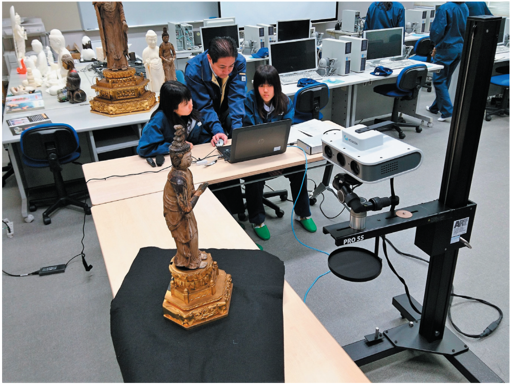
図2 3Dスキャナーによる計測作業
